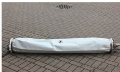
Bild 2: Janßen Process Riss- und Scherbensanierung sowie Stützensanierung (Isocyanatharz)
